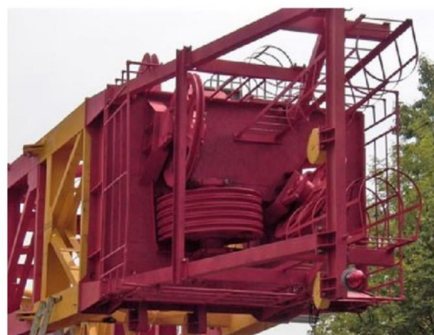
Кронблок шифрының үлгісі УКБ-6-250. У - Уралмашзавод конструкциясы, КБ - Кронблок; 6 - Шкивтер саны; 250 - Жүккөтергіштігі, тонна бойынша
